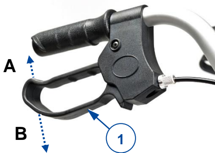
Figuur 9: Remhendel gebruiken
