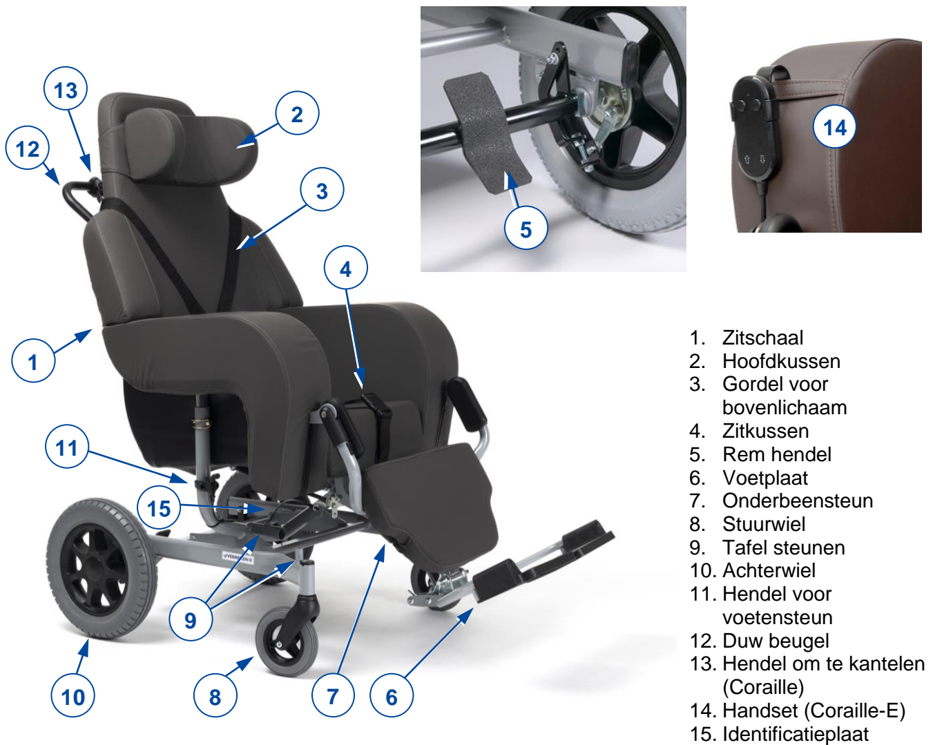
Figuur 2 Belangrijke onderdelen, Coraille, Coraille-E
