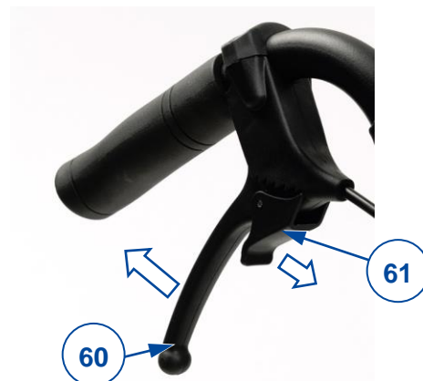
Figuur 7 De trommelremmen bedienen
