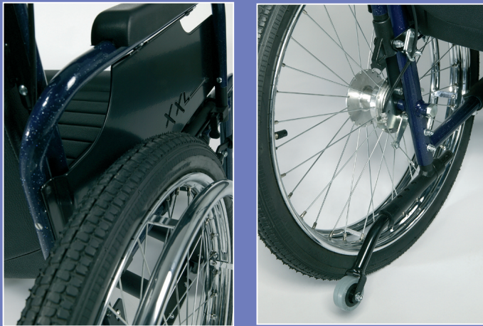
Trommelremmen B74 (standaard) Anti-tipping B78 (optioneel)
